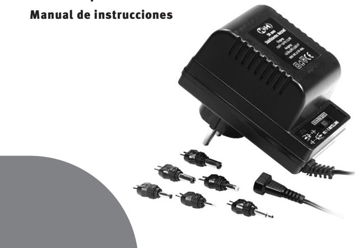
**SN 1000 ist ein stabilisiertes, kurzschlussfestes Universalnetzteil für elektrische und elektronische Kleingeräte mit einer Spannung von 1,5–12 Volt und einer maximalen Stromaufnahme von 1000 mA.**
